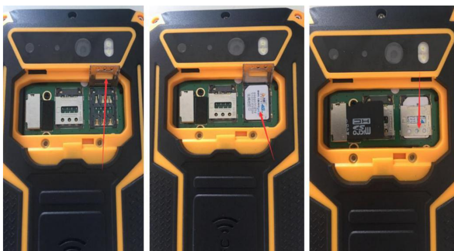
图 2.4-2 N7000R SIM 卡安装示意图
